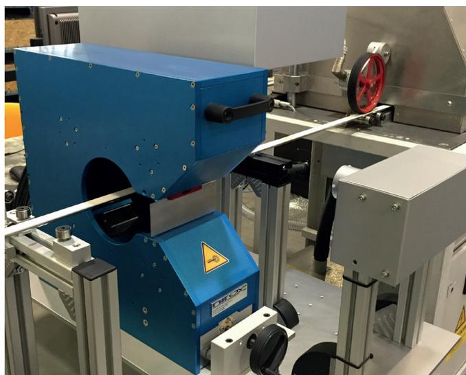
Il sistema di **rilievo del profilo esterno** è applicabile a **qualsiasi materiale** opaco, sia caldo che freddo, e consente di misurare **in continuo in linea di produzione** e con **precisione micrometrica**:
