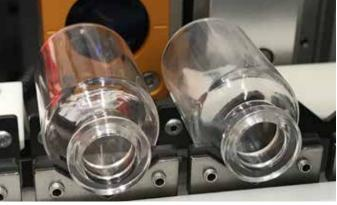
Considerando la severità dei requisiti di produzione relativi alle dimensioni nel packaging farmaceutico, è basilare il controllo dimensionale costante, incluso quello del fondo del contenitore per il ruolo fondamentale che ha per l'integrità del packaging nella fase di riempimento.
