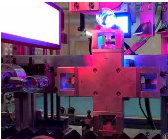
L'ispezione a telecamera è oggi un'attrezzatura necessaria in una linea di produzione di **trasformazione tubo all'avanguardia**. La famiglia **VISline.C** di sistemi di controllo a telecamera è stata ampliata per rispondere a **tutte le esigenze di ispezione direttamente in linea** di produzione.
