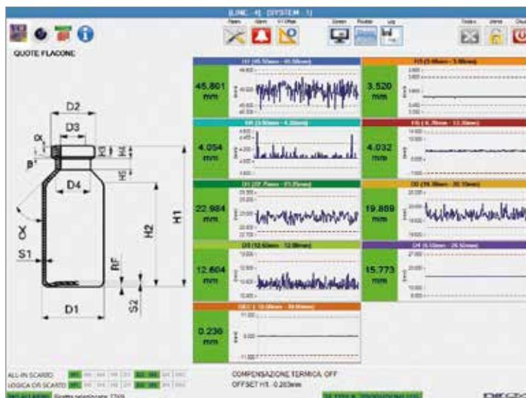
L'**ispezione dimensionale** viene solitamente eseguita sulla **macchina formatrice** quando il contenitore è ancora montato in un mandrino. Dopo questo, vi è l'ispezione prima del forno di ricottura, sulla **linea di post-formatura**, per **misurare il diametro interno e la lunghezza**. Entrambi sono disponibili **come una singola stazione**.
